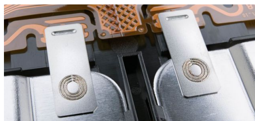
<p>System kontaktowania ogniwi do zestawów akumulatorów do pojazdów elektrycznych łączy poszczególne ogniwa akumulatora w jedną całość, tworząc w ten sposób warunki do przenoszenia energii elektrycznej z akumulatora do odbiornika. W produkcji seryjnej tego ważnego komponentu obowiązuje strategia zera błędów.</p>
