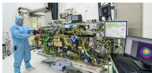
<p>Centralny element produkcji chipów: komponent najmniejszego na świecie impulsowego lasera przemysłowego, który stosowany jest do generowania światła, aby umożliwić litografię EUV.</p>
