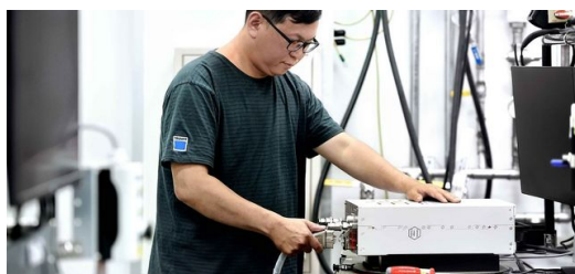
<p>Generatory TRUMPF sterują przepływem prądu i regulują natężenie, napięcie oraz czystotliwość na bardzo precyzyjne wartości.</p>
