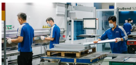
» Każdy pojedynczy uchwyt C musi być dokładnie przygotowany. Do tego INTER-TECH wykorzystuje szereg pras krawdziowych TRUMPF.
