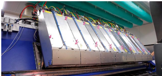
Die Boxen mit den Optiken sind in einer Brücke untergebracht, die die Förderstrecke überspannt. Bild: Ralf Kreuels
