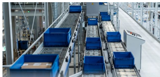
<p>Até 120 caixas circulam simultaneamente a uma altura de cinco metros pelo pavilhão da fábrica e transportam as peças de reposição para as diversas estações.</p>
