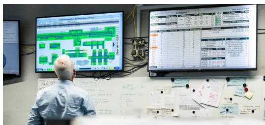
<p>Tudo visualizável: No chamado "posto de controle", monitores e painéis de controle mostram ao vivo onde cada componente está localizado no pavilhão do armazém.</p>
