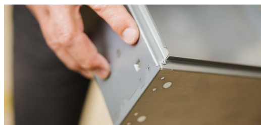
<p>Com a TruMatic 7000, a Max Knobloch consegue realizar até mesmo pequenas conformações, como estampagem em forma de concha ou uniões por cliques.</p>
