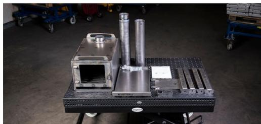
O fogão de campo para a Ucrânia é composto de 22 peças individuais. Todas elas foram cortadas automaticamente com um laser, depois dobradas e soldados. A alça do fogão serve como uma chave de fenda com a qual as peças individuais podem ser aparafusadas.
