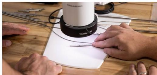
A equipe da Alpine Laser na inspeção de um stent.
