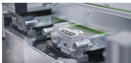
<p>Laser 2: Fazer o contato de cobre com o laser verde. O comprimento de
