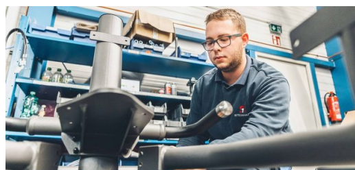
<p>A articulação de um equipamento fitness EGYM consiste principalmente em tubos de aço ovais. Após o processamento em uma máquina de corte de tubos a laser da TRUMPF, o equipamento recebe um acabamento sofisticado em cinza escuro através de revestimento em pó.</p>
