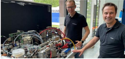
Colegas da TRUMPF de Schramberg modificaram o laser de luz verde para que brilhe no céu noturno. Normalmente, o laser verde é usado principalmente na indústria para soldagem de cobre.
