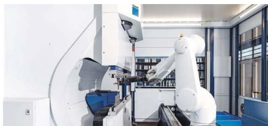
Célula de dobra inovadora de alta velocidade: A TruBend Cell 7000 é um sistema compacto que pode ser usado para dobrar peças pequenas de
