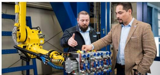
A automação robotizada para carga e descarga da TruBend Center 7020 também foi colocada em operação bem a tempo. Isto aumenta a velocidade do processo de produção", diz Michael Kuipers (à direita) e Karsten Hanenkamp acrescenta: "As pinças colocam as peças acabadas em paletes prontas para o transporte até a oficina de soldagem."
