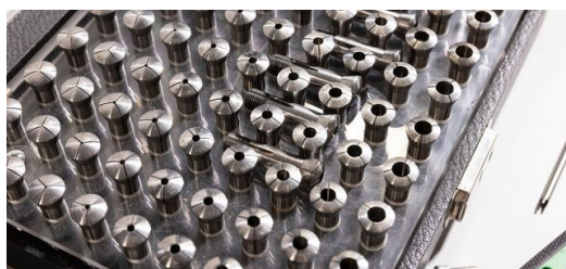
<p>Graças às ferramentas altamente flexíveis, o ajuste do suporte de peças e o alinhamento dos sistemas ópticos dura menos que cinco minutos: aqui as ferramentas para suporte de peças.</p>
