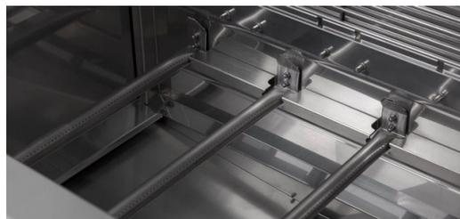
As quatro hastes de aço inoxidável dos queimadores das churrasqueiras a gás são cortadas em uma máquina de corte de tubos a laser TRUMPF e cada uma possui 144 furos. O diâmetro do furo, que diminui ao se aproximar da parte traseira, garante um aquecimento uniforme de toda a grelha.
