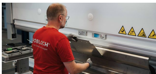
<p>Na dobradeira manual TruBend 5130, um funcionário usina peças de chapa para conjuntos de caixas de correio e produtos sob medida.</p>
