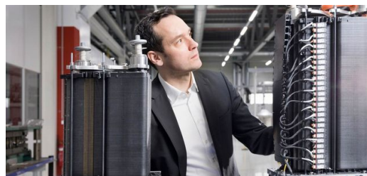
<p>Até 400 placas bipolares são empilhadas alternadamente com camadas de membrana em uma célula de combustível.</p>
