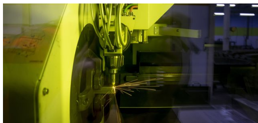
<p>Mașina de debitat țevi cu laser TruLaser Tube 5000 execută toate decupajele necesare în leavă.</p>
