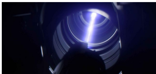
<p>Extrémne ultrafialové (EUV) svetlo kreslí budúce vodivé stopy ako drobné vzory do fotocitlivého laku.</p>
