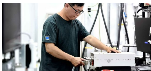
<p>Generátory TRUMPF ovládajú prúd a upravujú intenzitu prúdu, napätie a frekvenciu na veľmi presnú hodnotu.</p>
