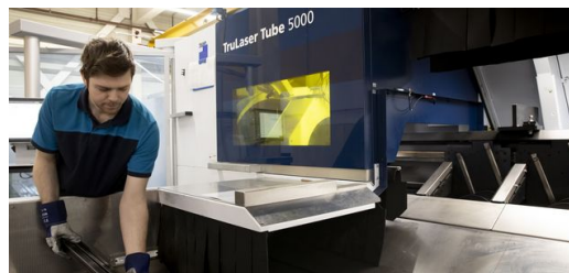
<p>Zo stroja TruLaser Tube 5000 sa dá vykladať manuálne, ale dokáže vyrábať aj bez obsluhy. Túto úlohu potom prevezme vykladacia stanica od partnera TRUMPF-u, spoločnosti transfluid.</p>
