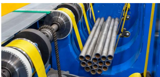
Efter att rören har skurits på TruLaser Tube 7000 transporteras rören till anläggningsnätverket, där roboten placerar dem i ett tråg och sedan separerar dem på ett bord.
