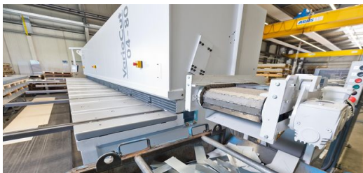
Eine an der EHT VarioCut angeschlossene Schneideanlage, zerteilt Schrott in kleine Stücke. Bild: Dirk Egelkamp
