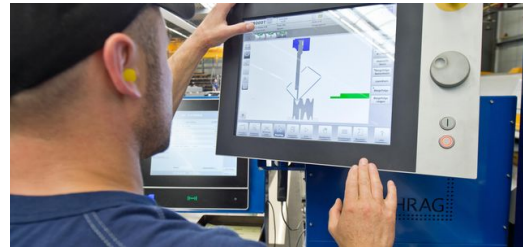
Über den hochauflösenden 17-Zoll-Color-Touchscreen-Flachbildschirm der Maschinensteuerung lassen sich 2D- und 3D-Programmierungen ebenso wie 3D-Simulationen aufrufen. „Die Handhabung der neuen Steuerung ist ähnlich wie bei einem Smartphone oder Tablet, das gefällt unseren jungen Bedienern“, erzählt Ingo Kleinau. Bild: Dirk Egelkamp
