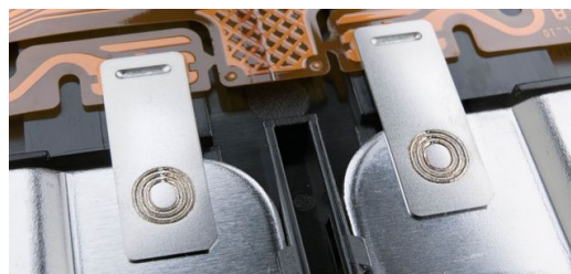
<p>Cellkontaktsystemet för batteripaket till elfordon kopplar samman de enskilda battericellerna till en enhet och skapar därmed förutsättningar för elektrisk kraftöverföring från batteri till förbrukare. Vid serieproduktion av denna viktiga komponent gäller nollfelstrategin.</p>
