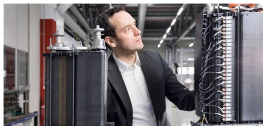
<p>Upp till 400 bipolära plattor staplas växelvis med membranlager i en bränslecell.</p>
