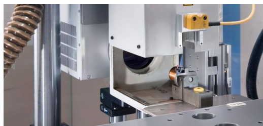
<p>Tidigare har TruMark 5010 lasern tagit bort isoleringslacken från koppartråden. Sedan kontaktades spolen.</p>
