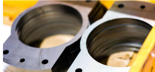
Thomas Sattler: „Das Verhältnis von Bohrungsdurchmesser zu Blechdicke ist klasse und macht die bisher häufig notwendige Fräsnacharbeit überflüssig. (Foto: Thomas Abé)
