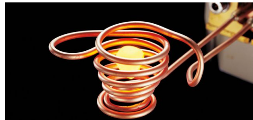
Im Feld der Spule befindet sich ein Schmelztiegel. Das einzuschmelzende Material wird in den Tiegel eingesetzt und durch induzierte Ströme erwärmt. Das elektromagnetische Feld überträgt die elektrische Energie berührungslos auf das Schmelzgut. (Foto: TRUMPF)
