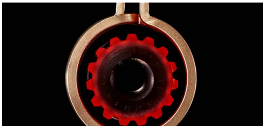
Induktives Härten eines Getriebeteils: Wie der Laser wirkt Induktion extrem lokal. Gute Voraussetzungen für die effiziente Zusammenarbeit in flexiblen Prozessketten. (Foto: TRUMPF)
