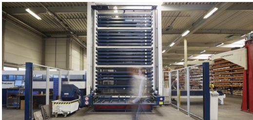
Der Mehrfachpalettenwechsler PalletMaster Tower lässt sich flexibel auf alle Anforderungen anpassen. Bei Koridon lagern in 20 Fächern alle für die unbeaufsichtigte Schicht benötigten Bleche (Foto: Claus Langer).
