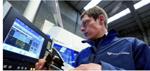
Das einfache Bedienkonzept der Software TruTops Tube ermöglicht die exakte Berechnung von Schnittgeometrien. Auch die komplexe Eckenberechnung rechteckiger Profile leistet das Programm automatisch. (Foto: Claus Langer)
