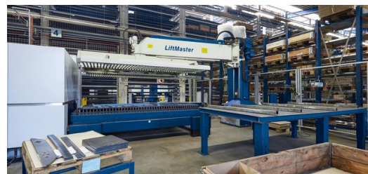
Ein Stopa-Hochregallager sorgt bei Schickling für Materialnachschub, ein LiftMaster für leichteres Teilehandling. (Foto: Claus Langer)
