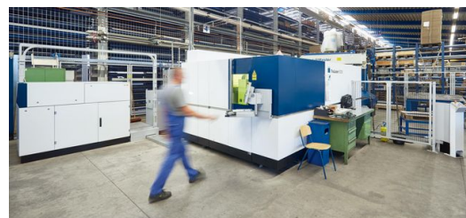
Ein Stopa-Hochregallager sorgt bei Schickling für Materialnachschub, ein LiftMaster für leichteres Teilehandling. (Foto: Claus Langer)
