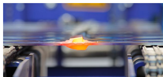
Das wird ein Messer: Die Spindelpresse hat die glühende Wulst zum Kropf
