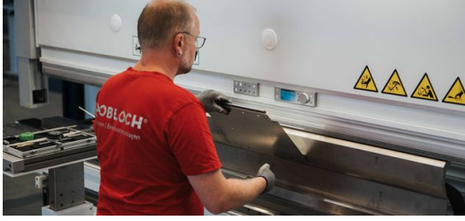
<p>Bir çalışan, manuel TruBend 5130 bükme makinesinde posta kutusu sistemleri ve özel üretimlere yönelik sac parçaları işliyor.</p>
