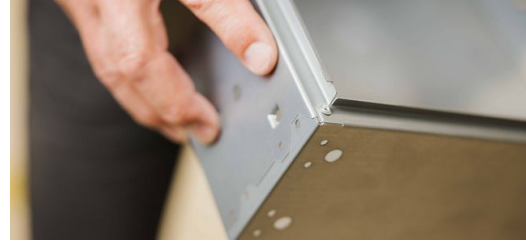
<p>Max Knobloch, TruMatic 7000 ile çanak kabartmalar veya klips bağlantıları gibi küçük form verme işlemlerini bile gerçekleştirebiliyor.</p>
