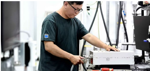
<p>TRUMPF jeneratörleri akımı kontrol altında tutar ve akım şiddetini, gerilimi ve frekansını özellikle hassas bir değere sabitler.</p>
