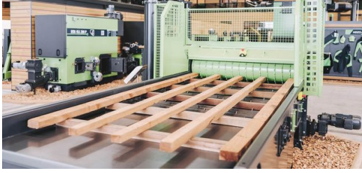
<p>Palet ögütücü: Atık paletlerden değerli yakıt elde ediliyor.</p>
