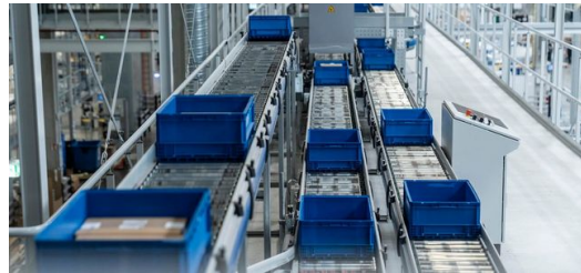
<p>Fabrika salonunda, 120 kutu beş metre yükseklikte eşzamanlı olarak dolaşarak yedek parçaları farklı istasyonlara taşıyor.</p>
